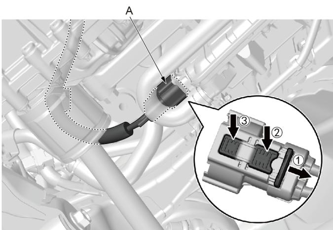
1.向后拨开锁止卡扣①，按压锁止卡②，脱开插接器直至插接器再次锁止，再次按住插接器锁止卡③，暖风加热器 PTC电缆插接器（A）。
