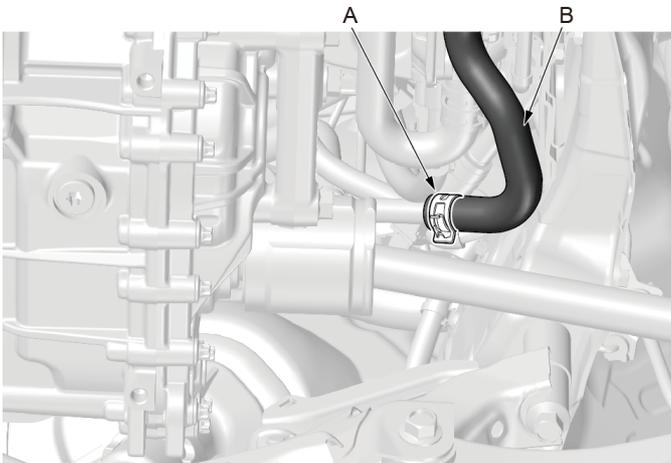
1. 使用水管卡箍拆装钳脱开暖风PTC出水管固定卡箍 (A)，左右摇晃脱开暖风PTC出水管 (B)。
