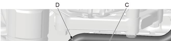
2. 使用水管卡箍拆装钳脱开暖风PTC进水管固定卡箍 (C)，左右摇晃脱开暖风PTC进水管
