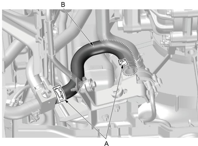
1. 使用水管卡箍拆装钳脱开暖风系统三通与暖风水泵连接水管固定卡箍（A）。
