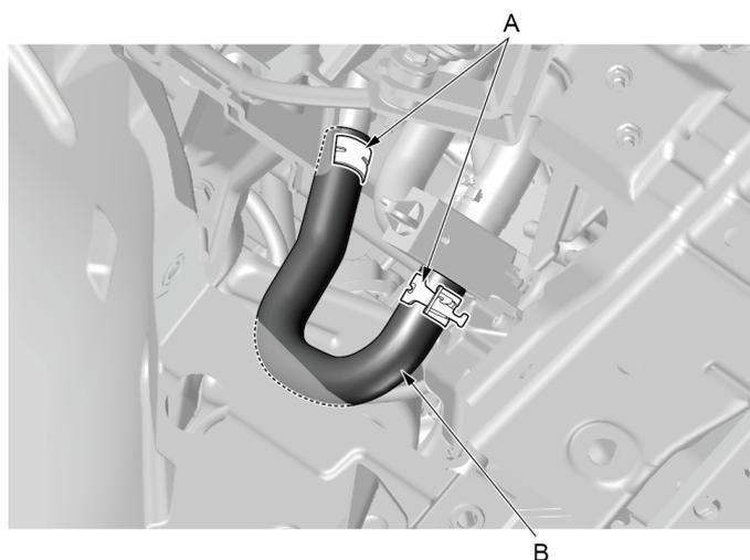
1.使用水管卡箍拆装钳脱开水管两端固定卡箍 (A)。
