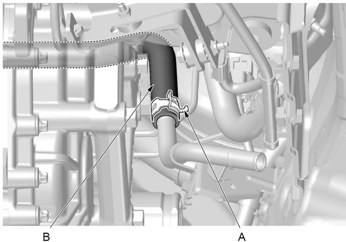
1. 使用水管卡箍拆装钳脱开加热芯金属进水管与加热芯进水管连接固定卡箍（A）。
