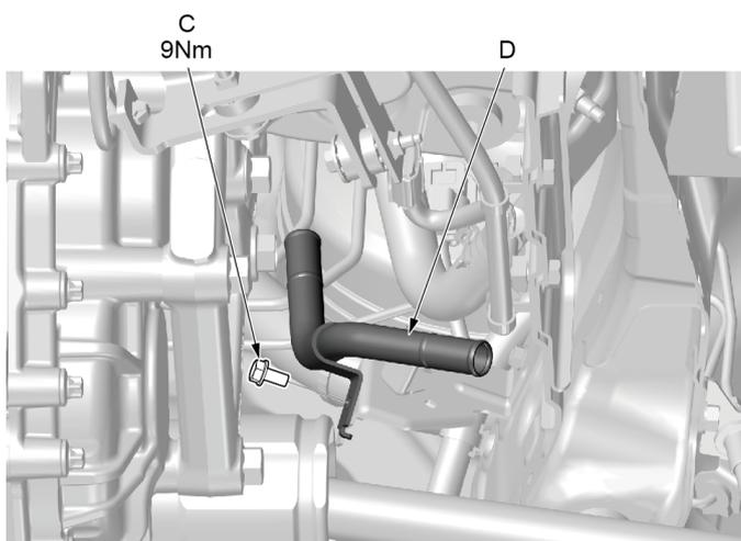
3. 使用 10mm 开口扳手拆卸加热芯金属进水管固定螺栓（C），并取下加热芯金属进水管（D）。
