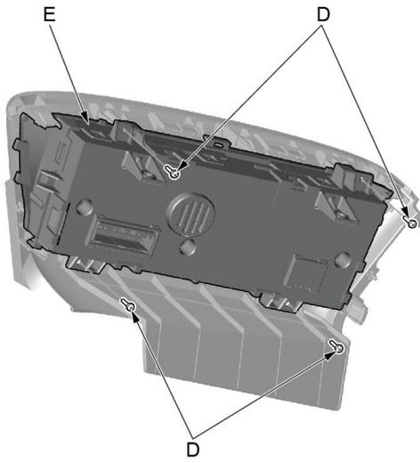
4. 拆卸气温控制单元固定螺钉 ( D )。
