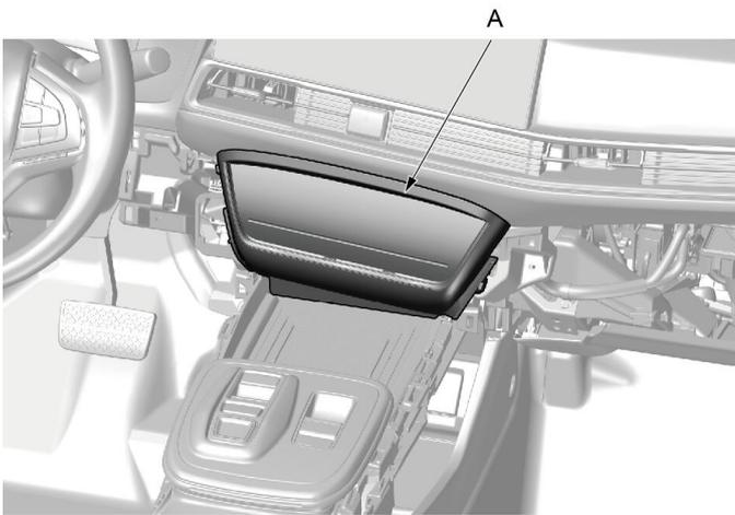
1. 使用内饰件拆卸工具拆下气温控制单元 (A)。
