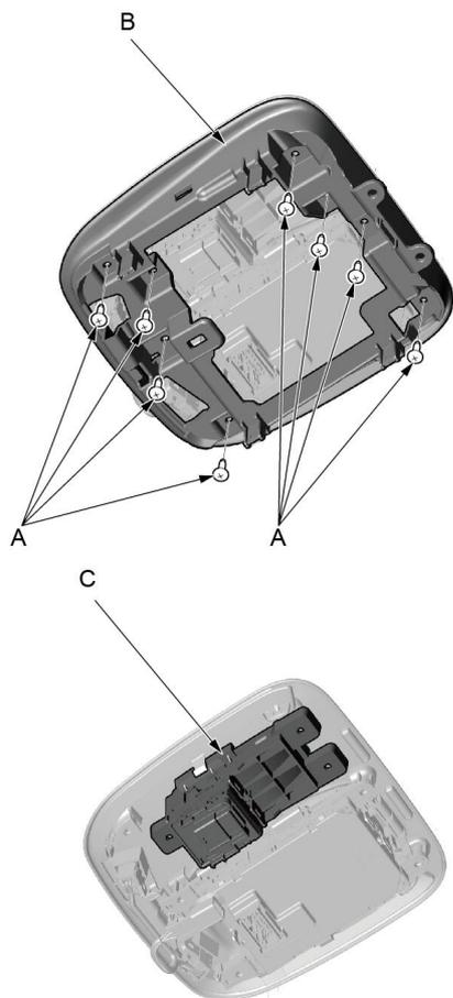
1. 使用十字起子拆卸8个固定螺钉 (A)。
