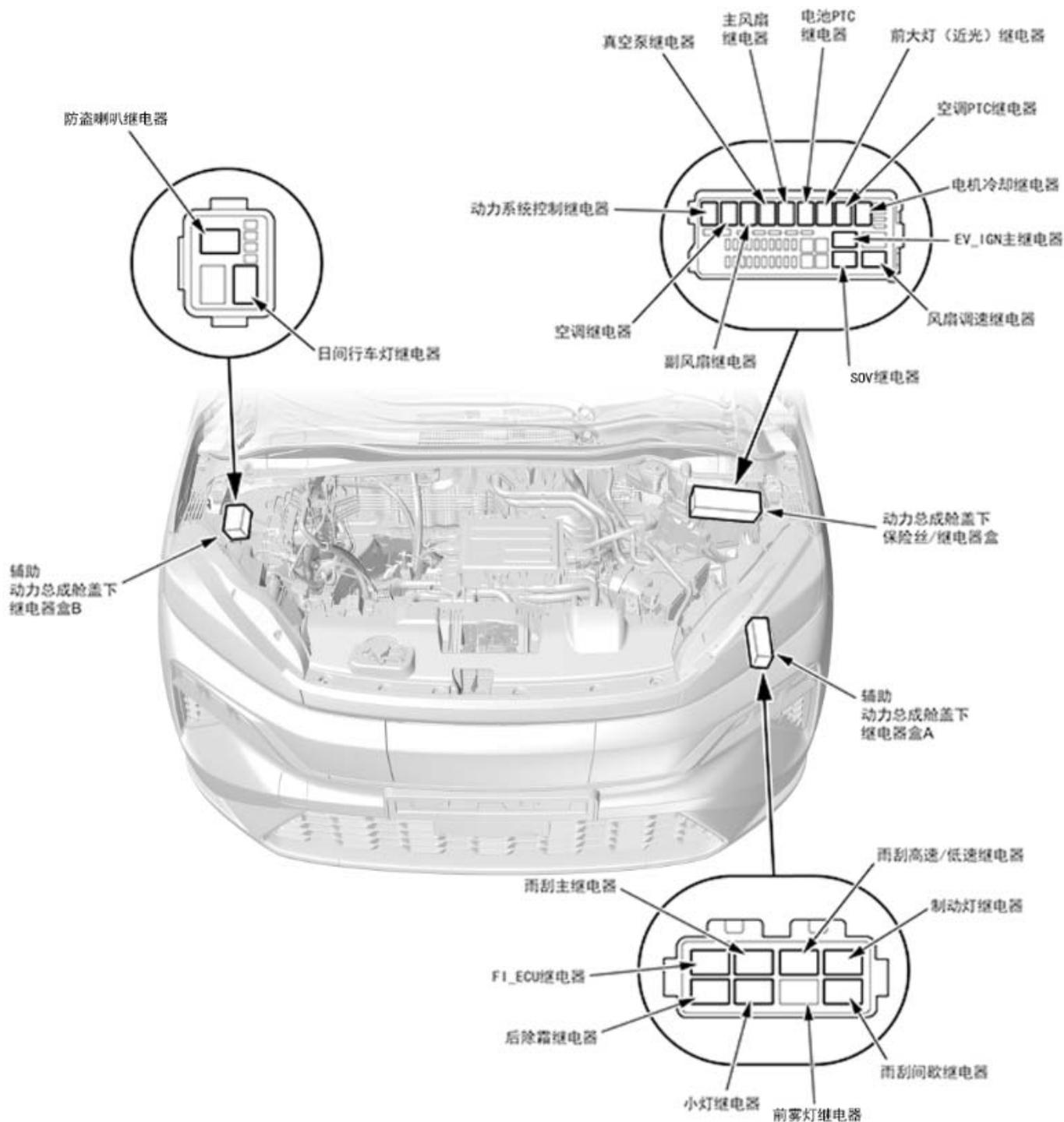
更换辅助动力总成舱盖下继电器盒A里继电器时，需将辅助动力总成舱盖下继电器盒A拆卸。
