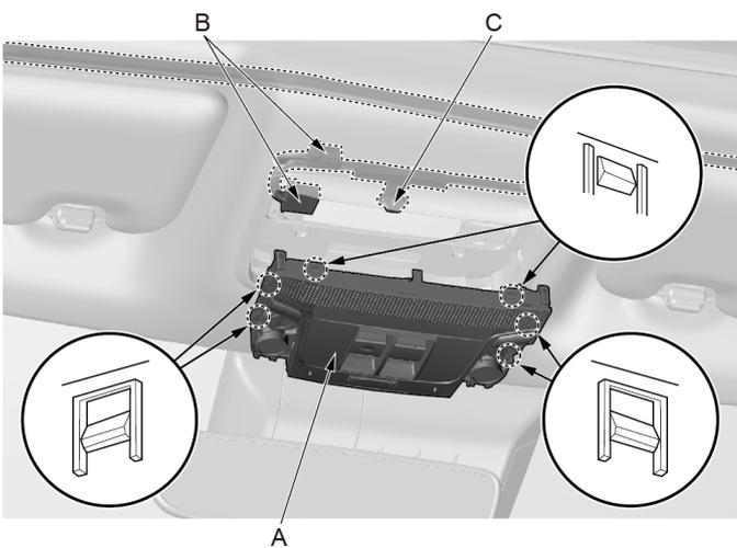
2.使用内饰拆卸工具拆下车顶控制台模块 (A)
