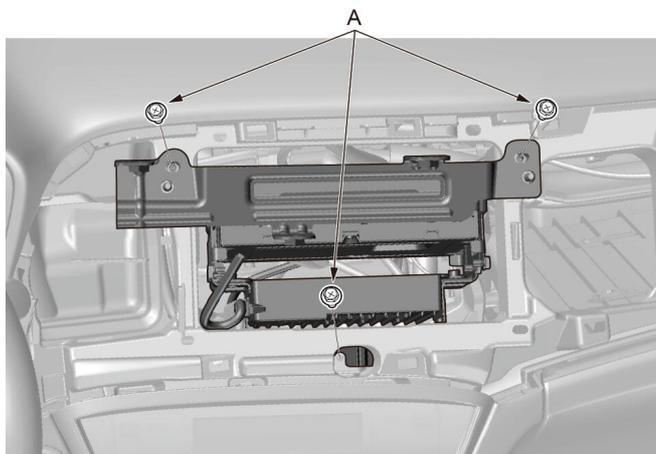
1. 使用8mm套筒拆卸音响单元总成固定螺栓（A）。
