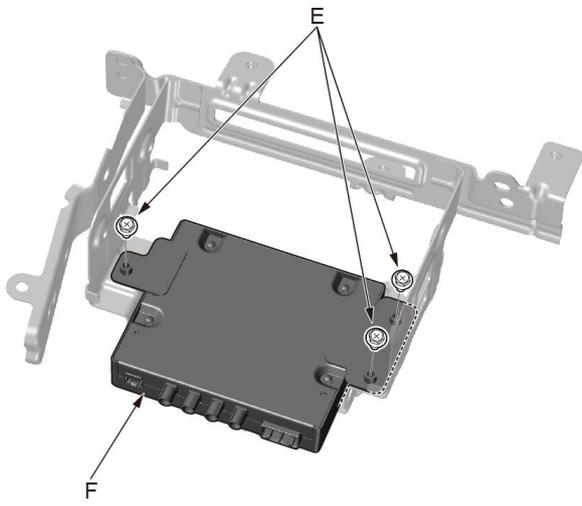
6. 使用10mm套筒拆卸音响单元固定螺栓 (E)。
