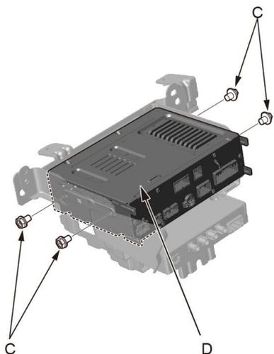
4. 使用10mm套筒拆卸远程信息处理单元支架固定螺栓 ( C )。
