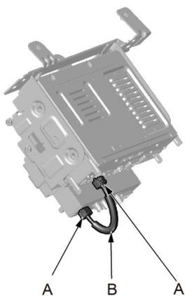
1. 按压远程信息处理单元与音响单元连接线束插接器锁止卡，脱开线束两端插接器 ( A )。
