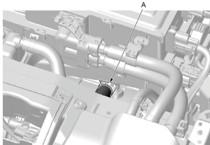
1. 使用水管卡箍拆装钳脱开驱动电机与散热器连接水管固定卡箍(A)。
