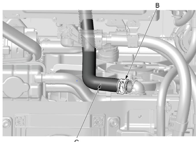
3. 使用水管卡箍拆装钳脱开驱动电机与散热器连接水管固定卡箍(B)。
