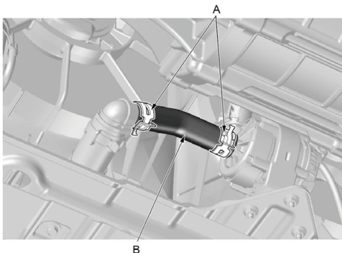
1. 使用水管卡箍拆装钳脱开驱动电机散热器与电动水泵连接水管固定卡箍(A)。
