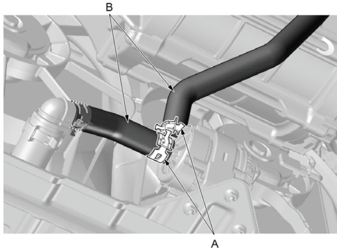
1.使用水管卡箍拆装钳脱开驱动电机电动水泵水管固定卡箍(A), 左右摇晃脱开驱动电机电动水泵水管(B)。
