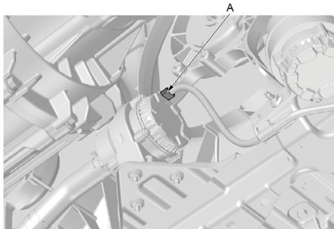
1.向下拨开锁止卡，并按住锁止卡脱开电动水泵电缆插接器(A)。
